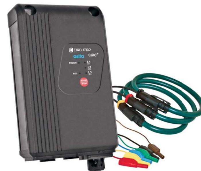
L'analizzatore **CIR/eP misura, elabora, calcola e registra** nella memoria SD sia il trend nel tempo dei parametri di rete ed energia (con cadenza da 1 a 120 minuti), sia gli eventi di qualità della fornitura elettrica (con dettaglio a 10msec), in modo continuativo e simultaneo.
