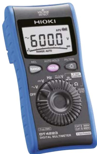
Multimetri digitali compatti, unici nel prevenire condizioni di pericolo a seguito di errate inserzioni. La struttura è a prova di caduta, resistente e leggera per ottimizzare le quotidiane attività di misura.
