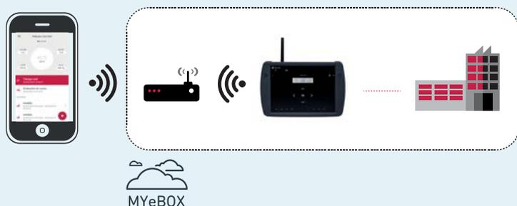
Configurazione e visualizzazione dati in tempo reale sulla APP, con connessione di entrambi i dispositivi alla rete wireless locale. L'accesso e la registrazione alla piattaforma Cloud permettono di condividere i file di analisi.
