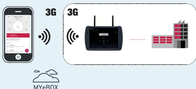
Configurazione e visualizzazione dati in tempo reale sulla APP, con connessione su rete cellulare 3G (solo MYeBOX®1500) di entrambi i dispositivi. L'accesso e la registrazione alla piattaforma Cloud permettono di condividere i file di analisi.
