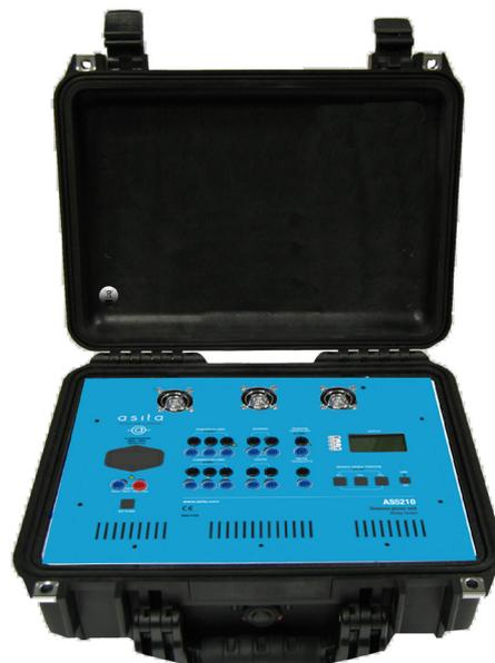
AS5210 è un sistema di prova delle protezioni di interfaccia (SPI) in Bassa Tensione e Media Tensione e delle protezioni generali (SPG) dedicato alle verifiche in campo, come prescritto dalle norme tecniche di riferimento: CEI 0-21: 2022-03, CEI 0-16: 2022-03.
