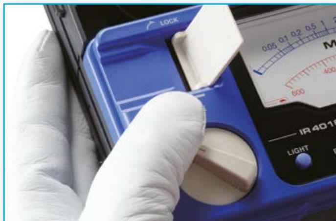
Per chi predilige la semplicità di lettura e la velocità di risposta offerta dagli indicatori analogici, i modelli IR401x rappresentano la soluzione ideale per la verifica della resistenza di isolamento. La gamma prevede 3 modelli in funzione della tensione di prova e della massima resistenza di isolamento misurabile.
