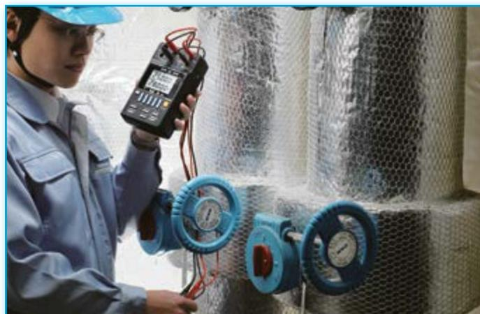
SS7012 è un calibratore dedicato alla verifica della strumentazione di processo, al controllo funzionale degli apparati industriali, nonché alle prove su circuiti e dispositivi elettronici. Oltre a generare e misurare segnali di tensione DC e corrente DC, SS7012 genera segnali termoelettrici corrispondenti alla temperatura equivalente misurata da 8 tipologie di termocoppie: K, E, J, T, R, S, B, N.
