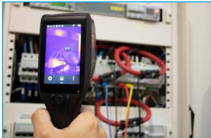
Le termocamere della Serie D sono termocamere professionali adatte ad ogni impiego. Grazie alla regolazione manuale (D192M e D384M) o automatica (D384A) della messa a fuoco offrono immagini nitide sia per oggetti distanti sia quando è invece necessaria una operatività ravvicinata come avviene generalmente per i quadri elettrici.
