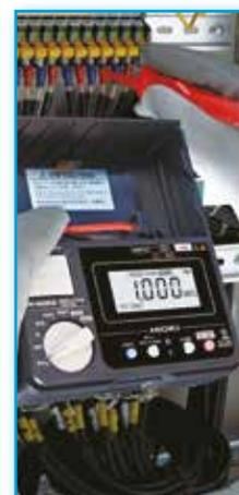
Misuratore della resistenza di isolamento dedicato alle verifiche di isolamento di pannelli e stringhe fotovoltaiche.
