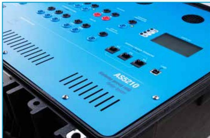
AS5210 è un sistema di prova delle protezioni di interfaccia (SPI) in Bassa Tensione e Media Tensione e delle protezioni generali (SPG) dedicato alle verifiche in campo, come prescritto dalle norme tecniche di riferimento: CEI 0-21: 2017, CEI 0-16: 2014, CEI 0-16\_V2: 2016, CEI 0-16\_V3: 2017.
