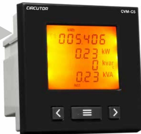
Gli strumenti della gamma CVM/C5 sono multimetri multifunzione per sistemi trifase che realizzano la misura dei parametri elettrici di base quali: Tensione, Corrente, Potenza Attiva/Reattiva/Apparente, Fattore di Potenza, Frequenza ed Energie. Tutti i modelli si installano a fronte-quadro con dima di foratura 96x96mm e dispongono di ingressi indiretti isolati di corrente (ITF) per TA con secondario .../1A e .../5A o per sensori miniaturizzati con uscita 250mA quali M1, MC3 e SC3.
