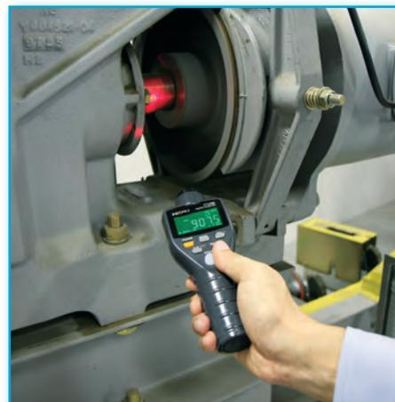
FT3405 e FT3406 sono tachimetri contagiri digitali ad elevate prestazioni per la misura a distanza della velocità di rotazione di parti meccaniche quali alberi motore, encoder, dischi, tramite sistema di misura a riflessione.
