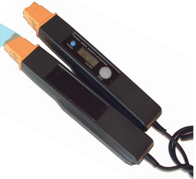
3258 è un voltmetro digitale che non ha eguali in termini di sicurezza e semplicità di utilizzo. La tecnologia di misura si basa su un sistema ad induzione brevettato, che consente la rilevazione del valore di tensione senza alcun contatto metallico con l'oggetto in esame, a beneficio della totale sicurezza dell'operatore.
