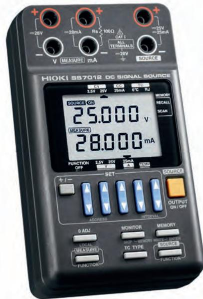
SS7012 è un calibratore dedicato alla verifica della strumentazione di processo, al controllo funzionale degli apparati industriali, nonché alle prove su circuiti e dispositivi elettronici. Oltre a generare e misurare segnali di tensione DC e corrente DC, SS7012 genera segnali termoelettrici corrispondenti alla temperatura equivalente misurata da 8 tipologie di termocoppie: K, E, J, T, R, S, B, N.
