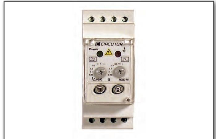
RGE/R sono relè di protezione differenziale a 2 moduli DIN con sensibilità di corrente e tempo di ritardo regolabili tramite potenziometro manuale. Questi dispositivi si abbinano ai toroidi della gamma WGC WGC-TP e WGS, e presentano sul fronte i 2 potenziometri di regolazione, 2 tasti per il reset e per la funzione di test nonché due LED di segnalazione d'alimentazione e di intervento del relè.
