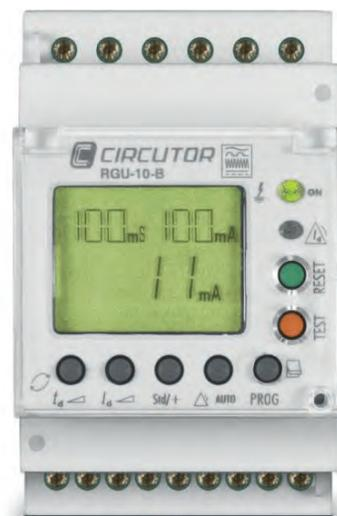
RGU10B è un relè di protezione differenziale e misuratore della corrente dispersa per segnali di tipo B (forma d'onda continua DC) con sensibilità di corrente e tempo di ritardo configurabili tramite tastiera locale.
