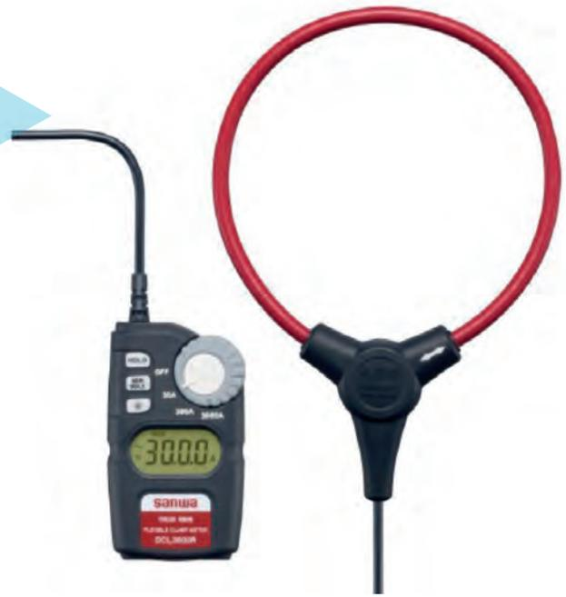
Il misuratore DCL3000R si distingue per la semplicità e praticità d'uso in quanto consente di svolgere misure di corrente alternata AC di basso ed elevato valore in spazi stretti ed angusti, grazie al sensore amperometrico flessibile fisicamente separato dal display di visualizzazione. Il vantaggio applicativo è confermato dalla sezione del sensore flessibile di soli 8.5mm e dalle dimensioni molto compatte del corpo centrale di chiusura dell'anello di corrente.
