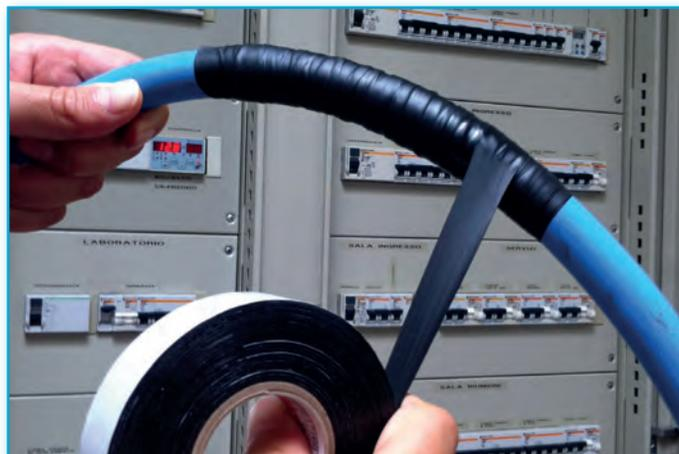
Il nastro autoagglomerante EPR900 è formato da uno speciale composto a base di gomma etilenpropilenica (EPR) che, in applicazione, si fonde su se stesso formando un blocco unico impermeabile e resistente agli acidi.
