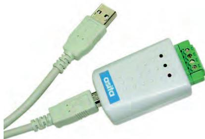
Il convertitore CVM/USB-RS485 trasferisce 2 reti dati RS485 su una porta USB di un computer con qualsiasi Sistema Operativo Windows. Ognuna delle 2 reti dati RS485 può gestire fino a 6 dispositivi di misura per un totale di 12 misuratori.
