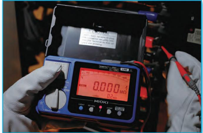
La gamma IR405x rappresenta la soluzione digitale ideale per la verifica della resistenza di isolamento (tensione di prova 50/125/250/500/1000Vdc) e la prova di continuità del conduttore di protezione (corrente di prova 200mA come indicato dalla norma CEI 64/8).
