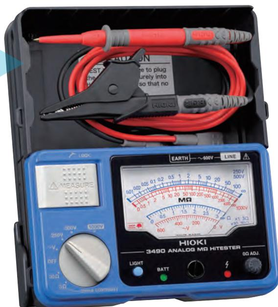
Per chi predilige la semplicità di lettura e la velocità di risposta offerta dagli indicatori analogici, 3490 rappresenta la soluzione ideale per la verifica della resistenza di isolamento (tensione di prova 250/500/1000Vdc) e la prova di continuità del conduttore di protezione (corrente di prova 200mA come indicato dalla norma CEI 64/8).
