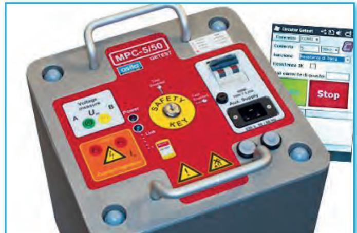
MPC5/50 esegue le misure di tensione e corrente in Vero Valore Efficace TRMS erogando un segnale di corrente con ampiezza elevata e di tipo impulsivo con una durata complessiva di 20ms (a 50Hz).
