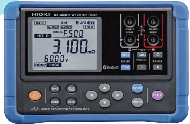
Tester prova batterie per verifiche immediate in campo su UPS, sistemi stazionari per alimentazione di sicurezza e di soccorso, centraline antifurto e antincendio e più in generale batterie ricaricabili per utilizzo industriale e dei trasporto.
