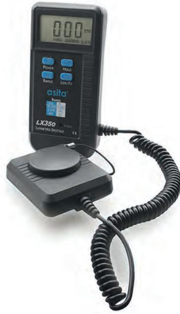
LX350 è un luxmetro digitale palmare per la misura dell'illuminamento tramite sensore semisferico fotodiode al silicio, per valori fino a 20000lux su 3 portate di misura. Il modulo del sensore è collegato al modulo indicatore digitale tramite cavo spiralato estensibile per consentire di eseguire le prove senza influenzare le misure a causa di ombreggiamenti e similari.
