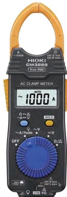
CM3289 è una pinza amperometrica per AC che incorpora un toroide di misura ad elevata tecnologia costruttiva, realizzato con sensore avvolto in aria (senza nucleo ferro-magnetico), con uno spessore delle ganasce di soli 8.3mm e una forma "a goccia" che ne consentono l'utilizzo in situazioni elettriche particolarmente caotiche e in spazi molto ristretti.
