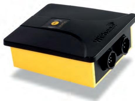
Wi-beee-MAX è un registratore dei parametri elettrici, studiato per la realizzazione di diagnosi energetiche approfondite volte ad ottimizzare l'efficienza energetica di un impianto elettrico o di una apparecchiatura elettrica complessa, che trova principale impiego in diagnosi energetiche di impianti elettrici, controllo preventivo e manutentivo delle cabine di trasformazione, analisi per il dimensionamento dei gruppi di rifasamento.
