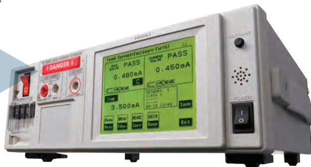
La misura delle correnti disperse è essenziale per la sicurezza. Molte normative, principalmente quelle che riguardano i dispositivi elettromedicali ma non solo, prevedono dei metodi di misura per verificare che il livello di correnti disperse attraverso il corpo del paziente o dell'operatore/utente o verso la messa a terra dell'impianto sia inferiore ad un limite massimo.
