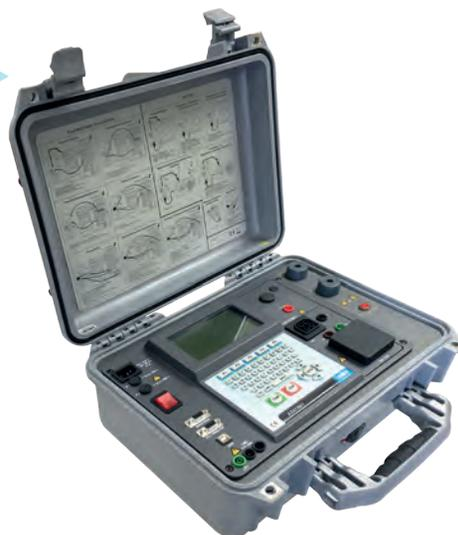
AS5130/1 è un sistema multifunzione per le verifiche di sicurezza elettrica su Quadri e Macchine Elettriche, come richiesto dalle ultime edizioni delle normative: CEI EN 60204-1 (CEI 44-5) per le macchine elettriche e CEI EN 61439-1 sui quadri elettrici.
