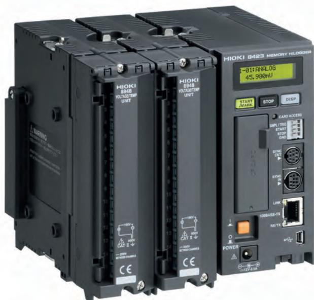
8423 è un vero e proprio sistema di acquisizione dei dati in grado di misurare e registrare fino a 600 canali contemporaneamente ad elevata velocità. Il sistema può campionare tutti i 600 canali ad un intervallo minimo di 10 ms!
