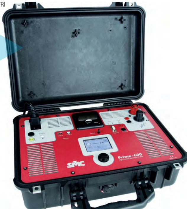
Il microhmetro PRIME600 è dedicato alla misura di bassi e bassissimi valori di resistenza con la particolarità di essere in grado di iniettare, sul circuito in esame, una elevata corrente di prova fino a 600A.
