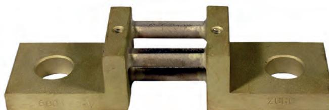
Derivatori shunt per misure di corrente DC, con caduta di tensione in uscita 60mV (altre uscite su richiesta). I derivatori o shunt di corrente sono dispositivi metallici, con o senza base di supporto in materiale isolante, che consentono di misurare correnti in DC anche elevate e di trasferirne il valore proporzionale in mV ad un misuratore o indicatore da quadro.
