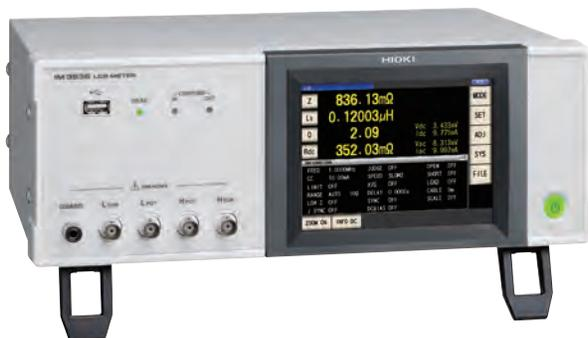
IM3536 è un ponte LCR “general purpose” che si adatta ad una ampia gamma di applicazioni, dalla ricerca e sviluppo su nuovi componenti, ai test laboratorio fino ai controlli in linea di produzione. La forza del mod. IM3536 è l'ampio spettro di regolazione della frequenza: dalla misura di resistenza in continua RDC ad una frequenza di test programmabile con continuità da 4Hz a 8MHz. Tensione programmabile da 10 mV a 5 V e corrente da 10 microA a 100 mA.
