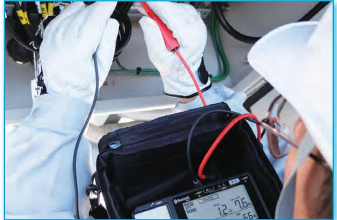
Tester per la prova dei diodi di bypass dei pannelli fotovoltaici che identifica istantaneamente i diodi di bypass danneggiati, alla luce del sole e senza oscurare i pannelli.
