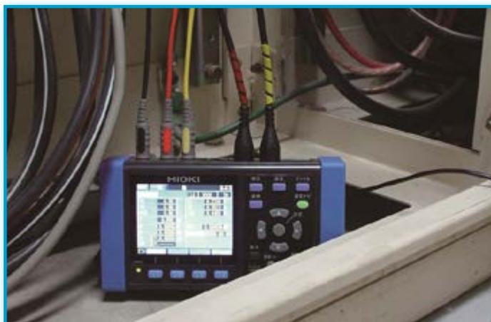
Gli analizzatori di rete PW3360 hanno un design molto compatto e accattivante con un display a colori completo e immediato. Sono la soluzione ottimale per effettuare le più svariate diagnosi energetiche, sia con registrazioni di breve durata ma rapide e frequenti, sia di tipo "tradizionale" con registrazione a lungo termine anche di durata superiore a 1 mese.
