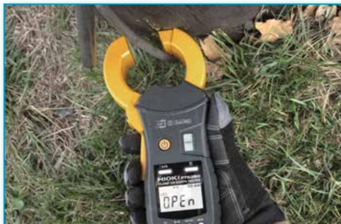
FT638x sono una coppia di analizzatori innovativi che rappresentano la soluzione strumentale ideale per le misure della resistenza di terra "impossibili" su impianti multi-dispersori.
