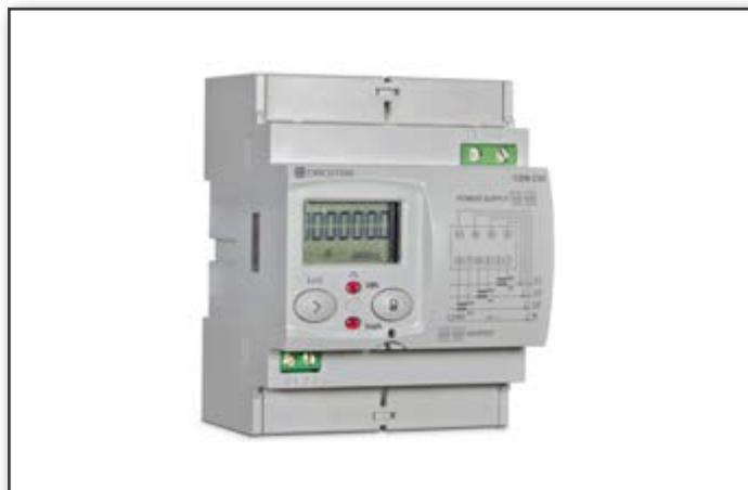
Contatori di energia trifase con ingresso indiretto di corrente per TA tradizionali con uscita xxx/5A e classe di precisione 1 (versioni non MID) come previsto dalla norma CEI EN 62053-21 relativa ai contatori statici di Energia Attiva e classe di precisione B (per le versioni MID) come previsto dalla norma CEI EN 50470 relativamente ai contatori di Energia utilizzabili a fini fiscali in accordo con la Direttiva Comunitaria MID 2014/32/EU.
