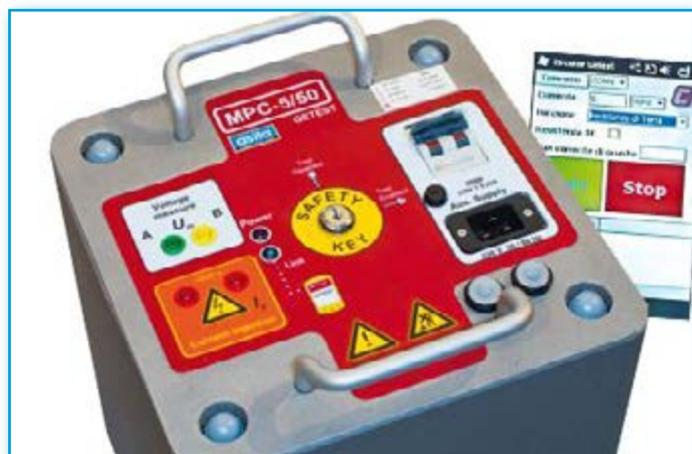
MPC5/50 esegue le misure di tensione e corrente in Vero Valore Efficace TRMS erogando un segnale di corrente con ampiezza elevata e di tipo impulsivo con una durata complessiva di 20ms (a 50Hz).
