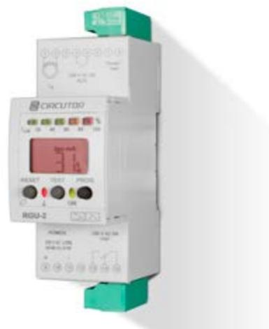
RGU2 è un relè di protezione differenziale e misuratore della corrente dispersa a 2 moduli DIN con sensibilità di corrente e tempo di ritardo configurabili tramite tastiera locale.
