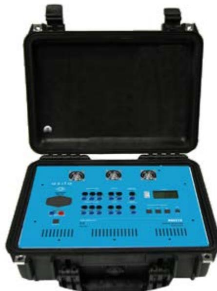
AS5210 è un sistema di prova delle protezioni di interfaccia (SPI) in Bassa Tensione e Media Tensione e delle protezioni generali (SPG) dedicato alle verifiche in campo, come prescritto dalle norme tecniche di riferimento: CEI 0-21: 2019-04, CEI 0-16: 2019-04.
