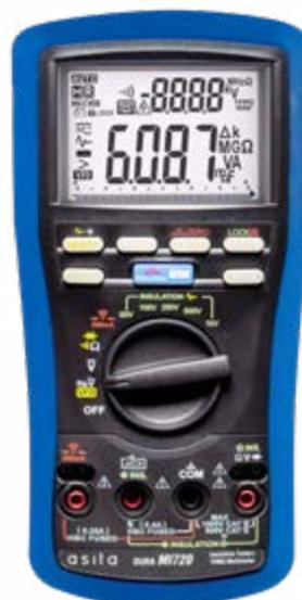
MI720 consente la verifica della resistenza di isolamento (con tensione di prova selezionabile sulle portate 50/100/250/500/1000VDC) e la prova di continuità del conduttore di protezione ed equipotenziali (con corrente di prova 200mA come indicato dalla norma CEI 64/8).
