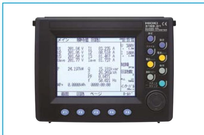
L'analizzatore di potenza e di armoniche 3169 è un dispositivo di misura dedicato alle prove su diversi tipi di apparecchiature, monofase a 2 fili o a 3 fili nonché trifase a 3 fili (senza neutro) e a 4 fili.
