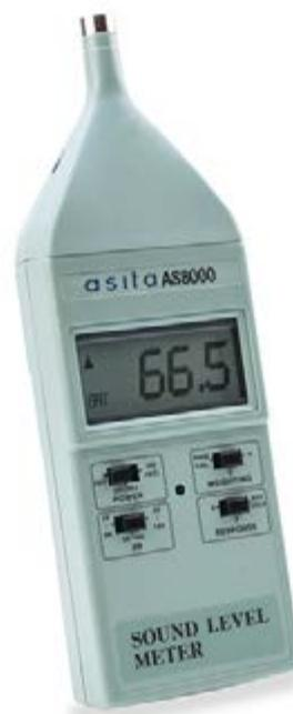
AS8000 è un fonometro digitale di tipo 2 rispetto alla norma IEC651, previsto per controlli di ispezione ed idoneo per la misura dei livelli acustici ambientali tipicamente richiesti per i controlli di ispezione, le verifiche di esposizione istantanea all'inquinamento acustico, i livelli di insonorizzazione, ecc...
