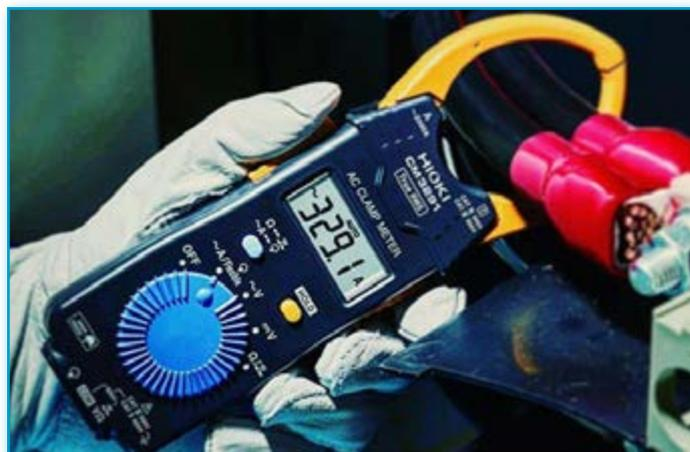
CM3291 e CM3281 sono pinze amperometriche per la misura di corrente AC fino a 2000A che incorporano un toroide di misura ad elevata tecnologia costruttiva, realizzato con sensore avvolto in aria (senza nucleo ferro-magnetico), con uno spessore minimo delle ganasce di soli 9.1mm e una forma "a goccia" che ne facilita l'utilizzo anche in spazi molto ristretti.
