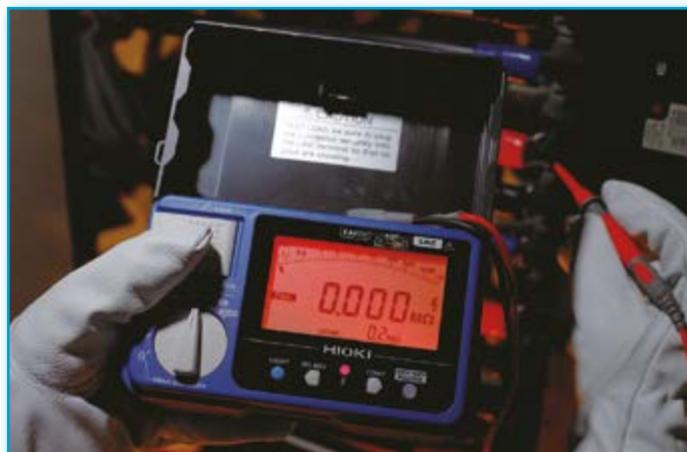
IR4056-20 e IR4057-50 sono una soluzione ideale per la verifica della resistenza di isolamento (tensione di prova 50/125/250/500/1000Vdc) e la prova di continuità del conduttore di protezione (corrente di prova 200mA come indicato dalla norma CEI 64/8).
