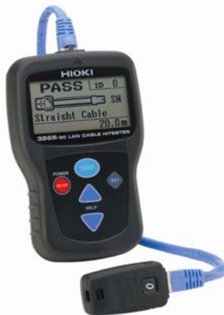
3665-20 è un tester portatile di verifica delle connessioni delle reti LAN, ideale per testare in velocità la mappatura dei cavi di rete individuando le anomalie sul cablaggio quali, cavi interrotti, cortocircuiti, coppie divise o incrociate ed altri errori sul cablaggio.
