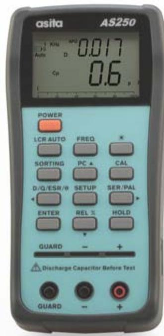
AS250 è un tester digitale pratico e palmare per le prove su componenti passivi quali resistenze, condensatori, avvolgimenti, bobine, trasformatori e motori.
