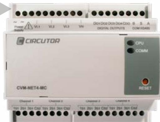
CVM/NET4P/MC3 è un complesso di misura che integra 12 canali di ingresso tensione/corrente in un unico dispositivo per installazione su barra DIN (6 moduli). In funzione della configurazione e dei sensori di corrente abbinato è quindi possibile ottenere fino a 12 analizzatori di rete monofase, fino a 4 analizzatori trifase o una libera combinazione monofase/trifase.
