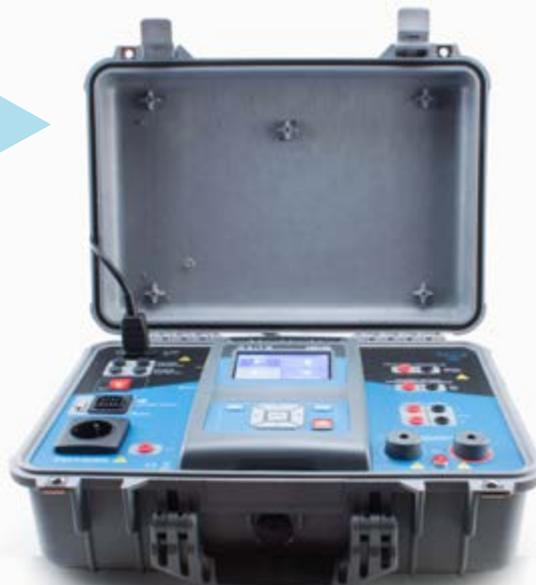
AS5160 è un sistema integrato multifunzione per le verifiche di sicurezza elettrica su numerosi dispositivi elettrici con cui è possibile realizzare prove elettriche al fine di soddisfare un ampio ventaglio di normative tecniche (CEI EN 60335, CEI EN 60950, CEI EN 61010, CEI EN 60204, CEI EN 61439, CEI EN 50191) e quindi disporre dei requisiti necessari ad ottenere la marcatura CE, la conformità UL o CSA, ecc.
