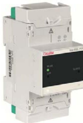
Line-EDS sono centraline di monitoraggio che integrano al loro interno un data-logger con capacità 512MB per la registrazione dei parametri misurati dagli strumenti collegati (circa 1 anno di dati con registrazione dei valori medi salvati con cadenza 15 minuti).
