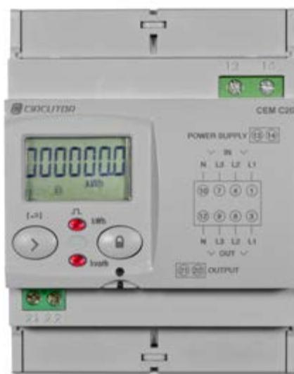
Contatori di energia trifase con ingresso diretto di corrente fino a 65A per ogni fase e classe di precisione 1 (versioni non MID) come previsto dalla norma CEI EN 62053-21 relativa ai contatori statici di Energia Attiva e classe di precisione B (per le versioni MID) come previsto dalla norma CEI EN 50470 relativamente ai contatori di Energia utilizzabili a fini fiscali in accordo con la Direttiva Comunitaria MID 2014/32/EU.
