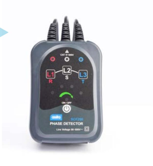
SCF200 è un indicatore del senso ciclico delle fasi con terminali a puntale o a coccodrillo per connessione diretta sul conduttore metallico delle fasi.
