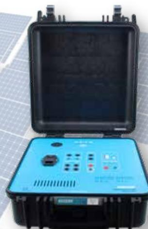
Sistema prova relè di interfaccia SPI installati su impianti fotovoltaici in Bassa Tensione e Media Tensione, dedicato alle verifiche in campo, in conformità alle norme CEI 0-21 e CEI 0-16. AS5200F si comanda tramite software installato su PC che ne consente la totale configurazione e la generazione del rapporto di prova; l'interfaccia utente è semplice, completa e immediata.
