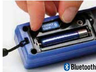
Z3210 è un adattatore per la connessione Bluetooth® che permette di aumentare le prestazioni dello strumento abbinato, in termini di registrazione dati e di condivisione istantanea delle misure con altri operatori. Z3210 va inserito nel relativo slot dello strumento come una normale chiave USB.
