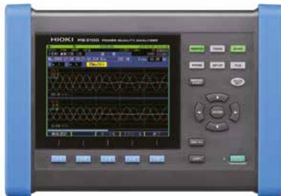
PQ3100 è un analizzatore della qualità di rete completo e di facile utilizzo, ideale per monitorare e registrare anomalie di alimentazione, anche per lunghi periodi, permettendo di individuare rapidamente le loro cause e di valutare gli effetti di disturbo presenti sui circuiti di alimentazione quali picchi e cadute di tensione, sfarfallio, armoniche e altre fluttuazioni elettriche.
