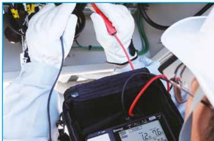
Tester per la prova dei diodi di bypass dei pannelli fotovoltaici che identifica istantaneamente i diodi di bypass danneggiati, alla luce del sole e senza oscurare i pannelli.
