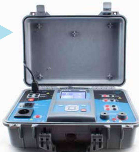
AS5160 è un sistema integrato multifunzione per le verifiche di sicurezza elettrica su diverse tipologie di apparecchiature/dispositivi elettrici. E' possibile realizzare prove elettriche al fine di soddisfare un ampio ventaglio di normative tecniche (CEI EN 60335, CEI EN 60950, CEI EN 61010, CEI EN 60204, CEI EN 61439, CEI EN 50191) e quindi disporre dei requisiti necessari ad ottenere la marcatura CE, la conformità UL o CSA, ecc.
