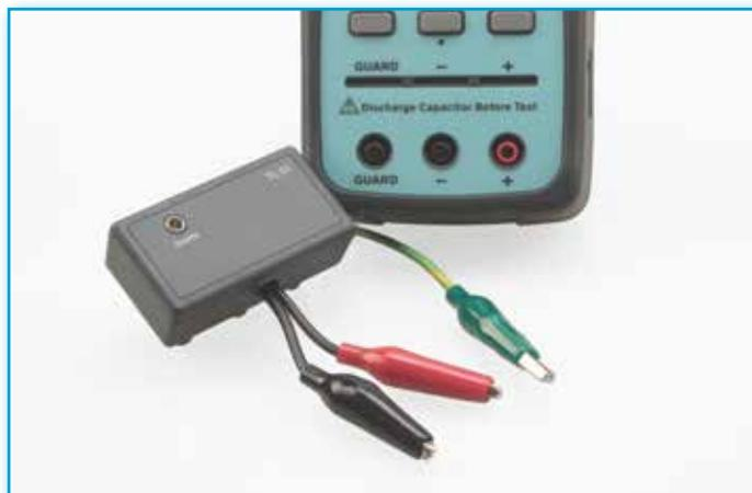
AS250 è un tester digitale pratico e palmare per le prove su componenti passivi quali resistenze, condensatori, avvolgimenti, bobine, trasformatori e motori.
