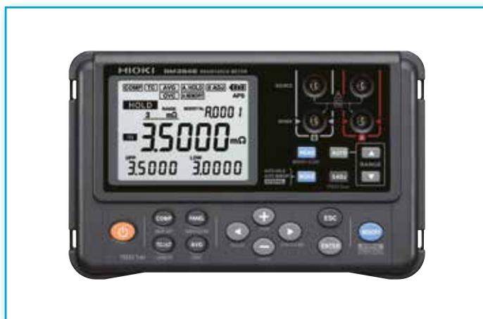
Misuratore di resistenza per verifiche immediate in campo, ad esempio su avvolgimenti di bobine motori e trasformatori nonché per il controllo delle connessioni e dei cablaggi di linee elettriche, elettroniche e di gestione dei dati su veicoli elettrici, veicoli ibridi ed aeromobili.
