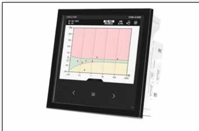
CVM/A1500 è un analizzatore della qualità di rete con display grafico digitale touch-screen a colori che dispone di software embedded di analisi e gestione energetica EMS (Energy Management Software) e web-server html5 integrato che consente a più operatori all'interno della stessa rete LAN locale di accedere in tempo reale alle misurazioni e alle registrazioni, utilizzando un qualsiasi browser di Internet.
