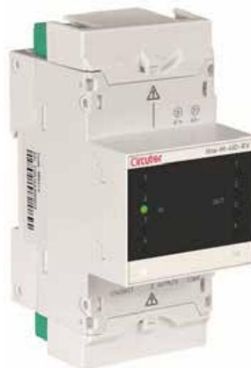
Modulo di acquisizione con 4 ingressi a relè che accettano contatti in tensione fino a 230V e 4 uscite a relè per estendere le funzionalità di Line-EDS e/o Line-CVM-D32, integrando il controllo di segnali ON/OFF in ingresso, la gestione di fasce tariffarie per la suddivisione dei consumi nonché attivare allarmi in uscita o piccole automazioni locali.
