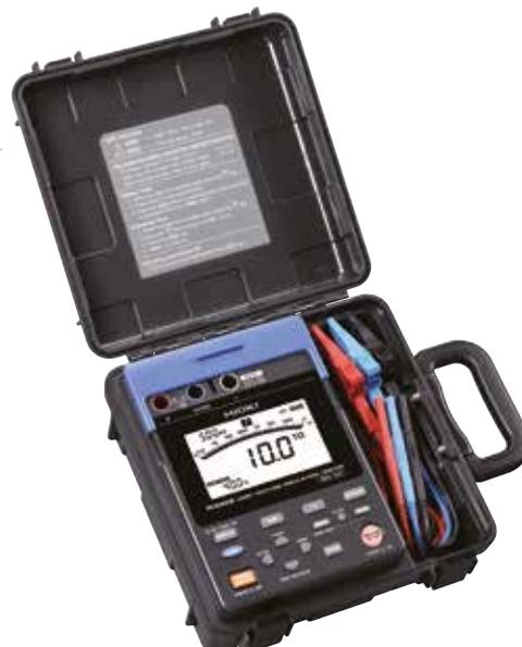
Misuratore della resistenza di isolamento ad elevate prestazioni, con tensione di prova programmabile fino a 5000Vdc e portata di misura di resistenza fino a 10TΩ.
