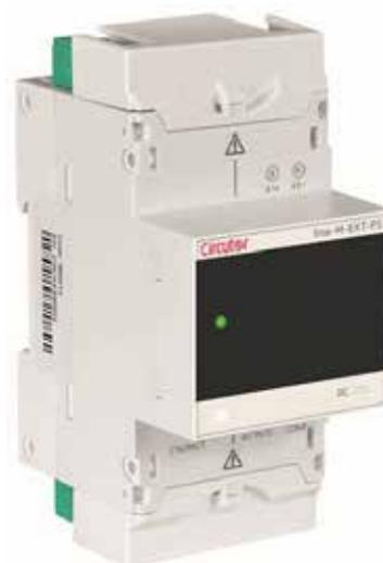
Line-M-EXT-PS è un alimentatore ausiliario da collegare a sinistra del Bus-Line dei dispositivi da alimentare. Eroga una potenza massima di 10VA, consentendo di alimentare un numero limitato di dispositivi.
