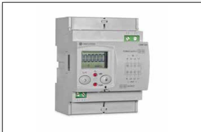
Contatori di energia trifase con ingresso diretto di corrente fino a 65A per ogni fase e classe di precisione 1 (versioni non MID) come previsto dalla norma CEI EN 62053-21 relativa ai contatori statici di Energia Attiva e classe di precisione B (per le versioni MID) come previsto dalla norma CEI EN 50470 relativamente ai contatori di Energia utilizzabili a fini fiscali in accordo con la Direttiva Comunitaria MID 2014/32/EU.
