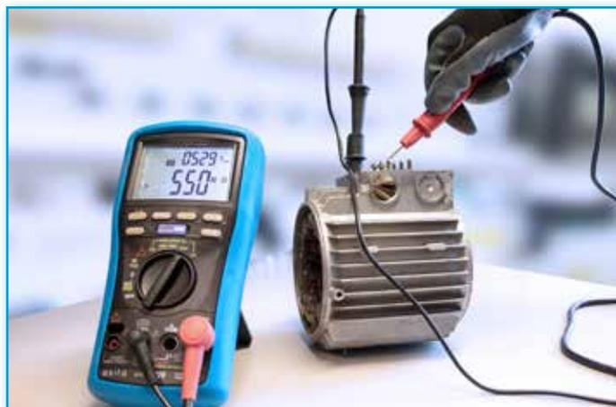
MI720 consente la verifica della resistenza di isolamento (con tensione di prova selezionabile sulle portate 50/100/250/500/1000VDC) e la prova di continuità del conduttore di protezione ed equipotenziali (con corrente di prova 200mA come indicato dalla norma CEI 64/8).
