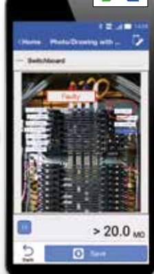
Mappatura dei punti in prova con relativi risultati direttamente sulla foto
