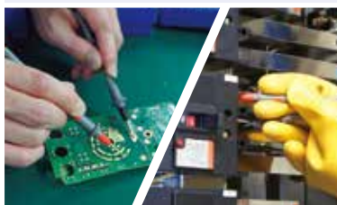
Indicazione acustica e visiva della condizione di continuità del circuito in prova e oltre-scala
