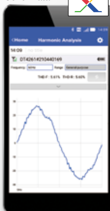
Visualizza e verifica la forma d'onda come un oscilloscopio
