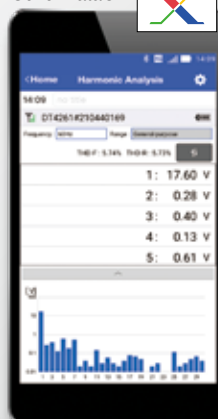
Analisi armonica per il controllo dei disturbi
