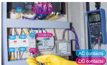
Riconosce automaticamente il tipo di tensione AC o DC
