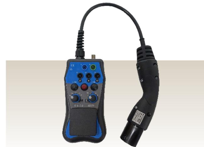
Di semplice utilizzo tramite i comandi sul pannello frontale per la programmazione diretta delle diverse condizioni di prova:
