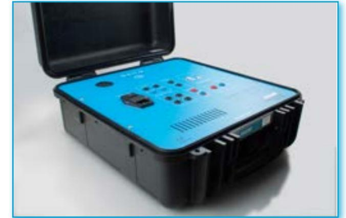
AS5200F è un sistema di prova dei relè di interfaccia SPI installati su impianti fotovoltaici (Utenti Attivi) in Bassa Tensione e Media Tensione dedicato alle verifiche in campo, come prescritto dalle norme tecniche di riferimento:
