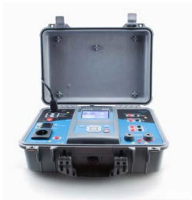
AS5160 è un sistema integrato multifunzione per le verifiche di sicurezza elettrica su diverse tipologie di apparecchiature/dispositivi elettrici. E' possibile realizzare prove elettriche al fine di soddisfare un ampio ventaglio di normative tecniche (CEI EN 60335, CEI EN 62368, CEI EN 61010, CEI EN 60204, CEI EN 61439, CEI EN 50191) e quindi disporre dei requisiti necessari ad ottenere la marcatura CE, la conformità UL o CSA, ecc.
