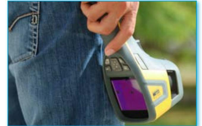
B160V coniuga semplicità di utilizzo a prestazioni professionali, caratterizzata da elevata risoluzione: 160x120 pixel e possibilità di visualizzare l'immagine termografica, l'immagine reale, il mix delle due immagini e l'integrazione delle due (Picture in Picture). Il sistema di lenti a fuoco fisso e l'operatività completamente in automatico, rendono rapida e semplice l'analisi termografica. E' una termocamera robusta e compatta, pensata per il cantiere.
