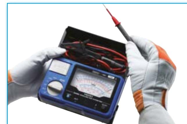
Per chi predilige la semplicità di lettura e la velocità di risposta offerta dagli indicatori analogici, 3490 rappresenta la soluzione ideale per la verifica della resistenza di isolamento (tensione di prova 250/500/1000Vdc) e la prova di continuità del conduttore di protezione (corrente di prova 200mA come indicato dalla norma CEI 64/8).
