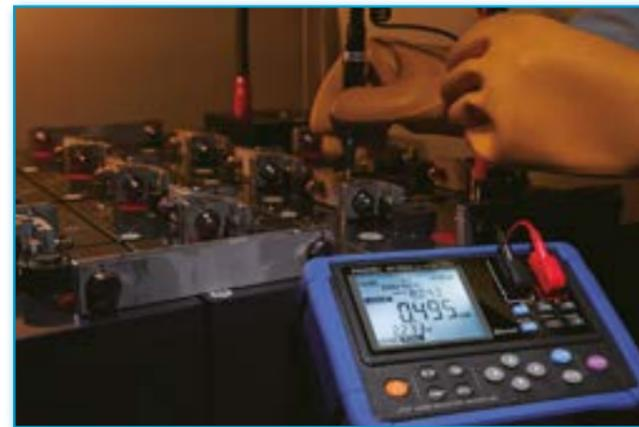
BT3554 sono tester prova batterie per verifiche immediate in campo su UPS, sistemi stazionari per alimentazione di sicurezza e di soccorso, centraline antifurto e antincendio e più in generale batterie ricaricabili per utilizzo industriale e trasporto.
