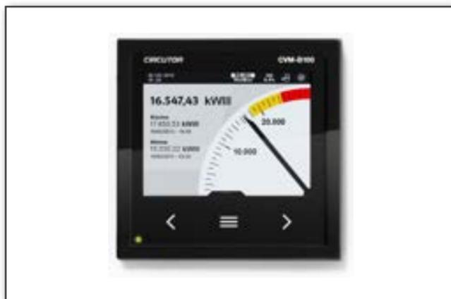
Le unità CVM/B100 e CVM/B150 sono analizzatori trifase dei parametri di rete installabili a fronte-quadro su pannello (rispettivamente con dimensioni: 96x96mm e 144x144 mm). Entrambi i modelli misurano e calcolano i principali parametri elettrici delle linee elettriche trifase e monofase con o senza neutro, equilibrate e sbilanciate, comprese le singole componenti armoniche fino al 50° ordine.
