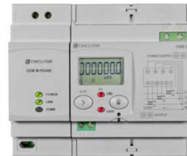
Contatori di energia trifase con ingresso indiretto di corrente per TA tradizionali con uscita xxx/5A e classe di precisione 1 (versioni non MID) come previsto dalla norma CEI EN 62053-21 relativa ai contatori statici di Energia Attiva e classe di precisione B (per le versioni MID) come previsto dalla norma CEI EN 50470 relativamente ai contatori di Energia utilizzabili a fini fiscali in accordo con la Direttiva Comunitaria MID 2014/32/EU.
