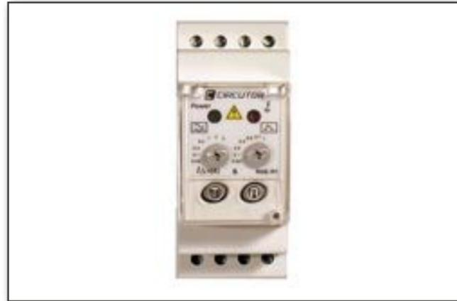
RGE/R sono relè di protezione differenziale a 2 moduli DIN con sensibilità di corrente e tempo di ritardo regolabili tramite potenziometro manuale.
