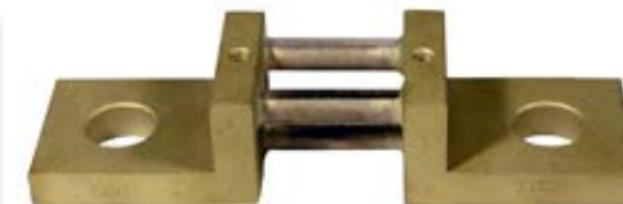
Derivatori shunt per misure di corrente DC, con caduta di tensione in uscita 60mV (altre uscite su richiesta). I derivatori o shunt di corrente sono dispositivi metallici, con o senza base di supporto in materiale isolante, che consentono di misurare correnti in DC anche elevate e di trasferire il valore proporzionale in mV ad un misuratore o indicatore da quadro.
