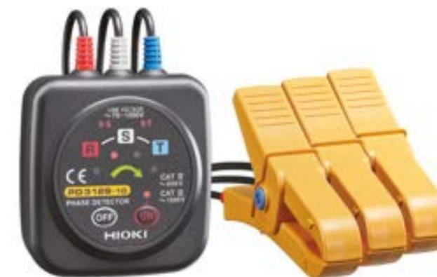
PD3129 e PD3129-10 sono indicatori del senso ciclico delle fasi dotati di un innovativo circuito di rilevazione della tensione tramite sensori induttivi che non richiedono il contatto elettrico su conduttore metallico.
