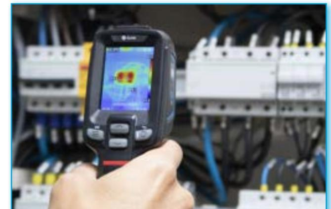
T120 è la termocamera ideale per l'installatore elettrico ed il termoidraulico: compatta, semplice da usare e dotata di un sensore con buona risoluzione 120x90 pixel.
