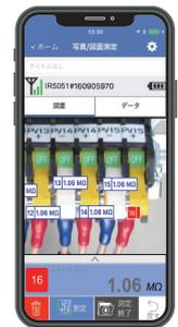
GENNECT CROSS permette la creazione del Report di prova in campo, acquisendo la foto della junction box sulla quale verranno posizionati i valori rilevati. Ciò permette di associare i risultati delle misure ai punti in prova mostrati nell'immagine.
