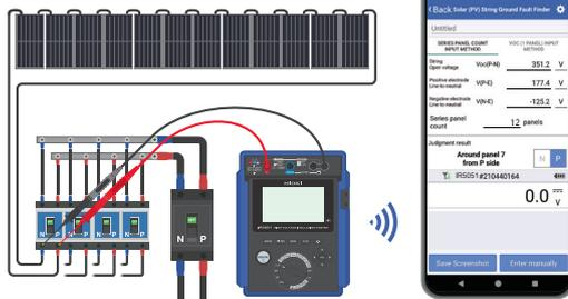
Utilizzando il modulo di comunicazione Bluetooth Z3210 opzionale, è possibile trasmettere alla APP GENNECT CROSS, la tensione di stringa misurata (2000V max), al fine di identificare il singolo guasto verso terra di un pannello. Pannello appartenente alla stringa precedentemente identificata con problemi di basso isolamento. L'APP elaborerà quindi il valore di tensione misurato unitamente al numero di pannelli della stringa per restituire l'indicazione del singolo pannello in dispersione.
