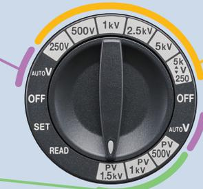
**Misura della resistenza di isolamento**
