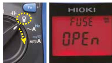
Verifica lo stato del fusibile interno per prevenire false misure
