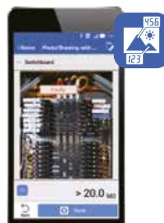
I valori misurati dallo strumento possono essere posizionati sull'immagine dell'oggetto in misura ottenuta tramite foto o file importato.
