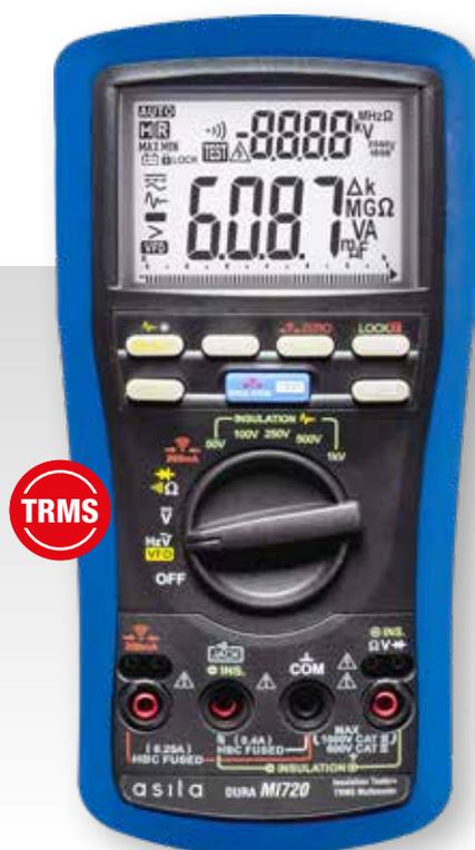
Misura la resistenza di isolamento (tensione di prova 50/100/250/500/1000VDC) ed esegue la prova di continuità del conduttore di protezione ed equipotenziali (con corrente di prova 200mA come indicato dalla norma CEI 64/8) oltre alle funzioni di multimetro.
