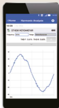
Visualizza la forma d'onda come un oscilloscopio
