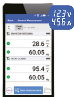
I valori misurati dallo strumento possono essere visualizzati e salvati sul dispositivo mobile in tempo reale.
