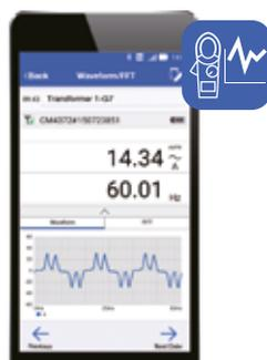
Visualizza le forme d'onda della tensione o della corrente in misura ed esegue l'analisi FFT.
